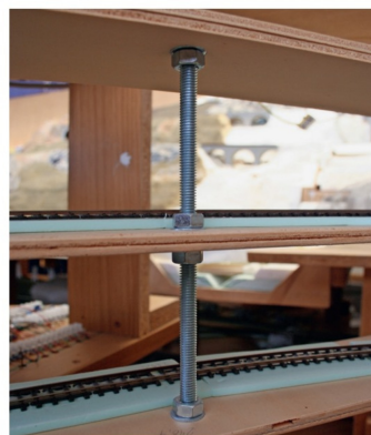
Mit der abschliessenden Feinjustierung werden auch die Muttern festgezogen.
