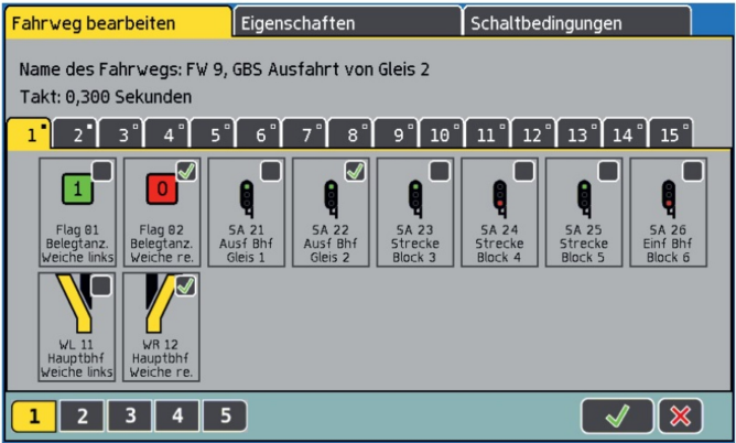
Die Aktionen des Fahrweges 9 für die Ausfahrt aus dem Bahnhofsgleis 2.
