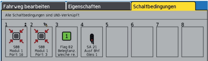
Ein etwas komplexerer Fahrweg mit vier UND-verknüpften Schaltbedingungen.
