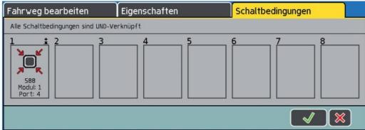
Die Schaltbedingungen eines Fahrweges, angezeigt in der Übersicht.
