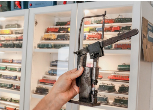
Dieses Spezialgerät diente dazu, spezielle Federn herzustellen.
