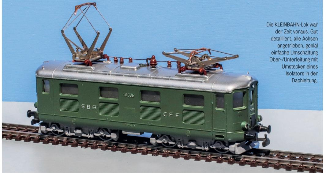
Die KLEINBAHN-Lok war der Zeit voraus. Gut detailliert, alle Achsen angetrieben, genial einfache Umschaltung Ober-/Unterleitung mit Umstecken eines Isolators in der Dachleitung.
