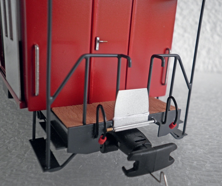
Das Resultat der Plattformgelenkerfertigung mit dem Einsatz einer Lötlehre.
