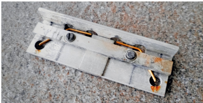
Die Lötlehre hier mit zwei eingespannten Geländerteilen für einen Personenwagen der FO.
