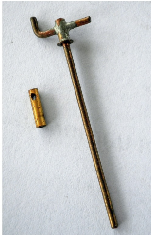
Hülse ( \varnothing 1,5 \times 1 \text{ mm} ) mit Querloch ( \varnothing 1 \text{ mm} ) für die Handkurbel und unverputzte Kurbel.
