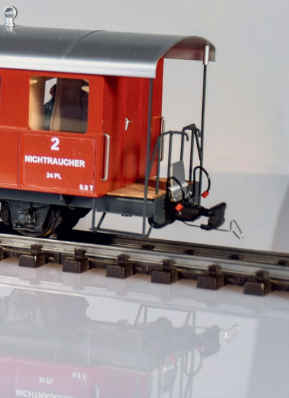
Hülse ( \varnothing 1,5 \times 1 \text{ mm} ) mit Querloch ( \varnothing 1 \text{ mm} ) für die Handkurbel und unverputzte Kurbel.
