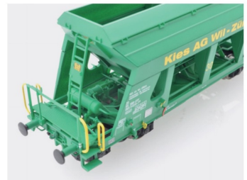
Blick auf die Rangierbühne mit vielen freistehenden Luftleitungen und der Aufstiegsleiter.
