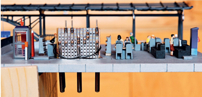
In jedem Gebäude laufen alle Beleuchtungsanschlüsse auf einem Print zusammen.
