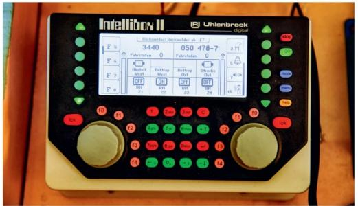
Direkt an der Zentrale Rückmelder schalten: Man kann sich so Abläufe schaffen, bei denen nur mit virtuellen Rückmeldern gearbeitet wird.
