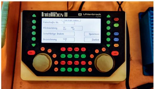
Jede Fahrstraße der Intellibox 2 wird über eine Rückmeldung gestartet. Wahlweise kann das eine Belegt- oder eine Freimeldung sein.
