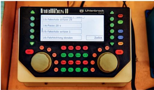
Mittels Fahrstrassen kann man mit der Intellibox 2 auch die Fahrtrichtung einer Lokomotive ändern und damit komplexe Abläufe steuern.
