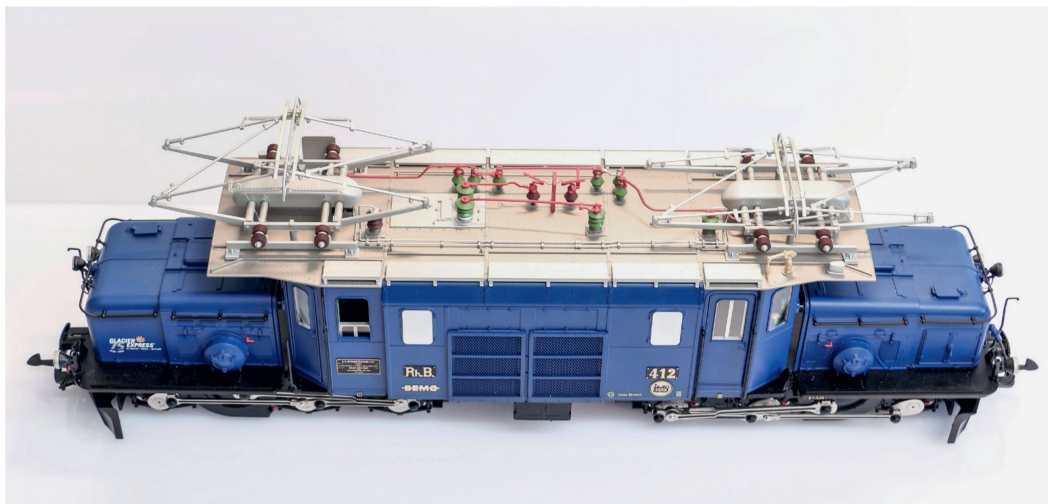
Das blaue Krokodil, die Ge 6/6' 412, weist ihren Schwestern gegenüber eine andere Anordnung der Isolatoren und Leitungen auf dem Dach auf.
