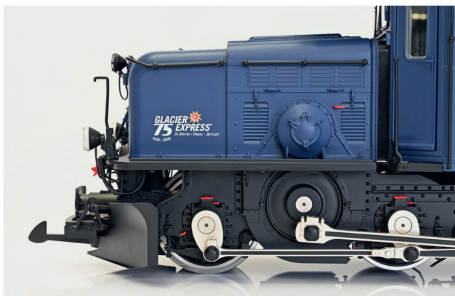
Zwischen Lokkasten und Vorbauten ist eine schwarze Abdeckung aus Gummi angebracht.
