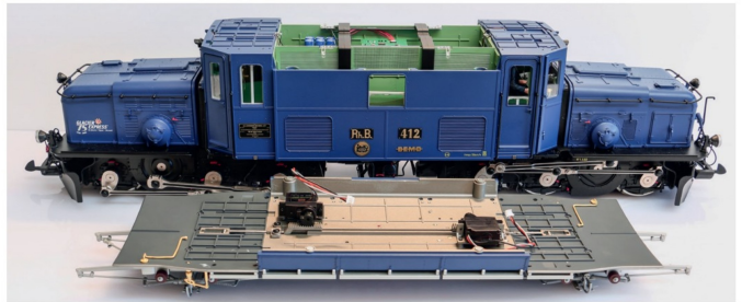
Das Dach wird von mehreren Magneten gehalten und kann einfach abgenommen werden.
