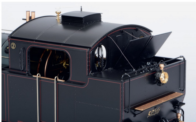
Der Kohlekasten kann partiell zugeeckt werden, um Kohlestaub in der Kabine zu vermeiden.
