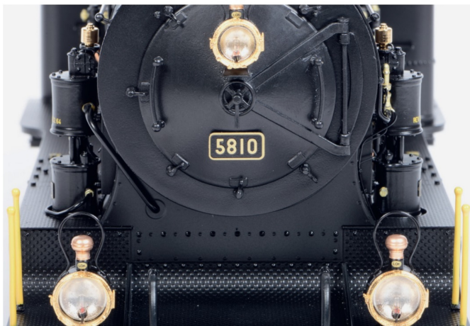
Sechs Maschinen wurden in den 1930er-Jahren beidseitig mit Luftpumpen ausgerüstet.
