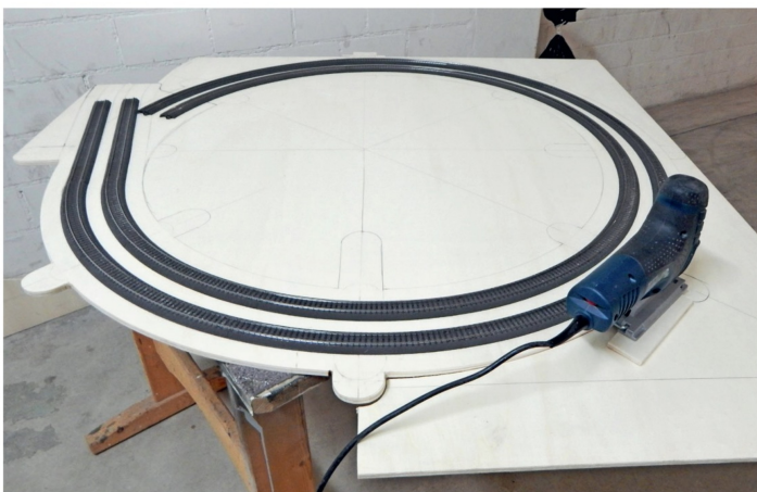
Für die Wendel werden drei 10 mm dicke Pappelsperholzplatten zurechtgesägt.
