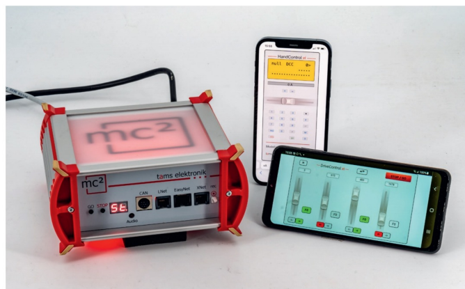
Aktivierter Notstopp: Die Anzeige zeigt «St» an, und oben leuchtet die Box in Rot statt Grün.
