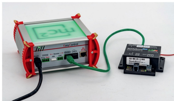
Die Box von der Rückseite her gesehen mit einem Fichtelbahn-Booster am BiDiB-Anschluss.
