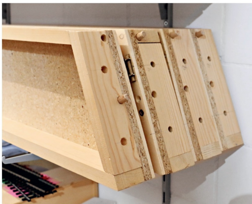
Sie werden mit Zentrierzapfen und Schrauben miteinander verbunden.
