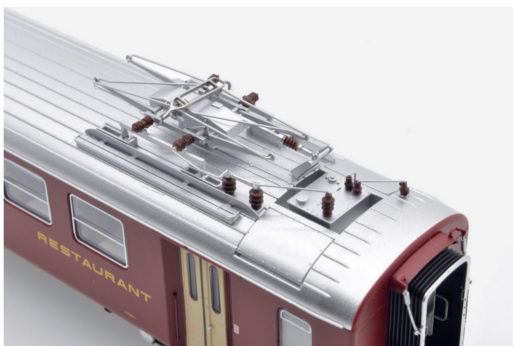
Der Stromabnehmer und der dazugehörige Trafo auf dem Dach.
