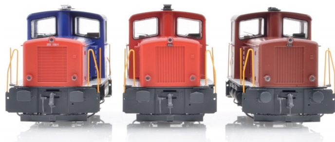
Gut erkennbar sind die unterschiedlichen Lüftergitter.
