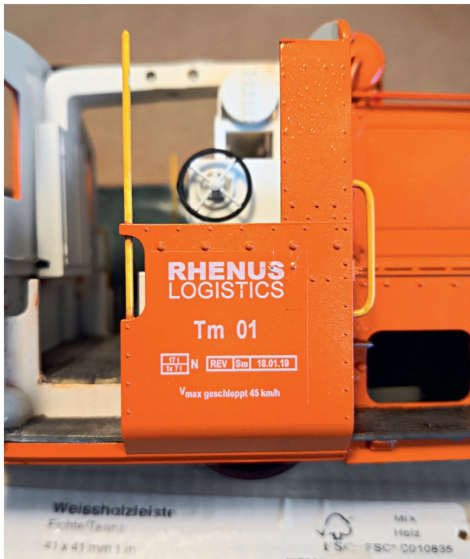
Die Decalfolie mit selbst gestalteter Beschriftung ist aufgebracht. Nun folgt das Verschmutzen.
