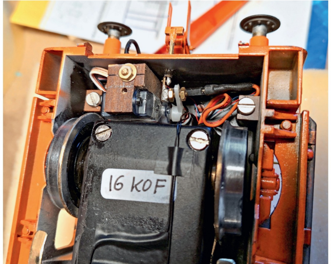
Angetrieben wird die Kupplung von einem Micro Servo. Für dessen Einbau blieb nicht viel Platz.
