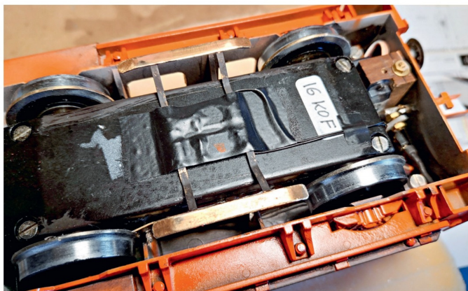
Zusätzliche Schienenschleifer aus Messingstreifen sorgen für eine perfekte Stromaufnahme.
