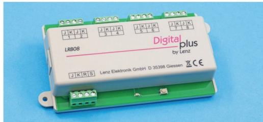
Digitalpionier Lenz bringt in diesem Jahr einen neuen kombinierten Belegt- und Rückmelder auf den Markt, den Digital plus LRB08 (Art.-Nr. 11230). Die Belegztstände von bis zu acht Gleisabschnitten können vom Produkt unabhängig überwacht werden, die Meldung der Zustände erfolgt über den RS-Bus an die Zentrale LZV200 (LZV100, LZ100). Damit kann die Verkabelung der Modellbahn im Vergleich zu den Baugruppen LR101 und LB101 ganz erheblich vereinfacht werden.
