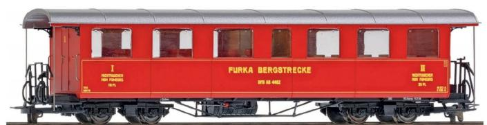
wurden zudem mit neuen SWS-Drehgestellen ausgestattet. Nach der ersten Auflage mit den ursprünglichen runden Torpedodachlütern kündigt BEMO jetzt die drei bisher noch nicht realisierten Fahrzeuge mit modernisierten flachen Dachlütern an:
