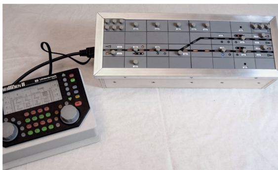
Die Anzeige von Rückmeldungen auf einem Stellpult ist eine der Königsdisziplinen. Dieses DrS2-Stellpult von Erbert wird am LocoNet der Intellibox II betrieben.
