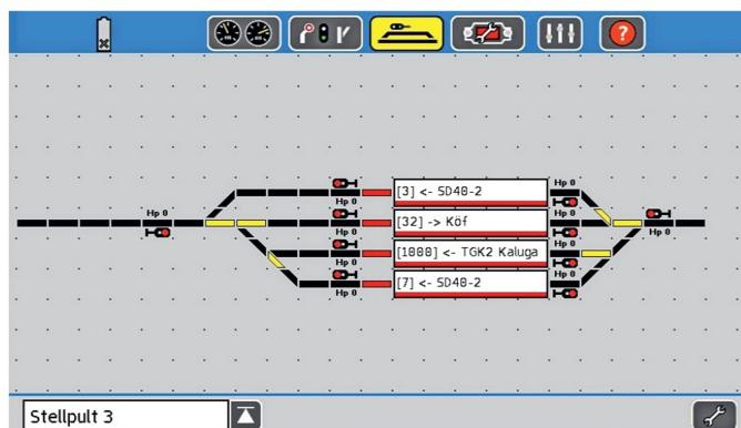
Das ist kein PC-Programm, sondern das in der ECoS von ESU integrierte Stellpult. Neben den Belegmeldungen kann man hier bei Einsatz der RailCom-Technik auch anzeigen, welches Fahrzeug sich wo befindet. Es wird sogar die Fahrtrichtung mit angezeigt.
