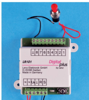
Direkt am Rückmelder LR101 von Lenz kann man auch Taster anschliessen.
