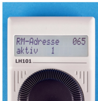
Im Display der LH101 und LH101-R lassen sich die RS-Bus-Rückmeldungen anzeigen.
