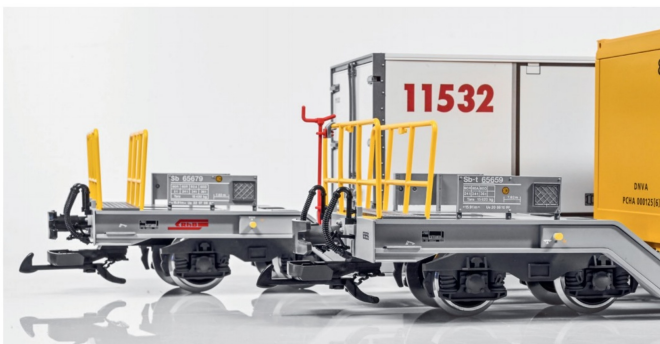
Im Bereich der Plattformen sind die unterschiedlichen Varianten der Handbremse zu erkennen.
