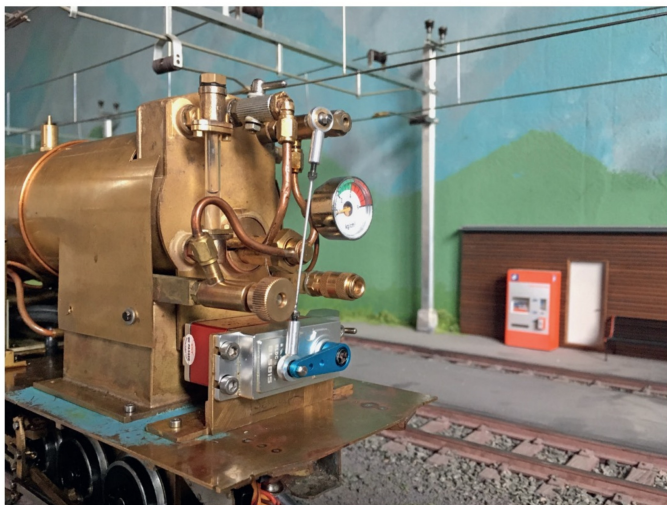
Wegen der Hitze konnte kein normaler Servo aus Kunststoff beim Kessel verbaut werden.
