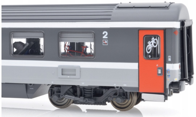
Das aus vier Einzelteilen bestehende Drehgestell besticht durch seinen Detailreichtum.
