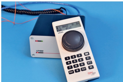
Über die Adresse 0 kann man mit einer aktuellen Digitalzentrale LZV200 von Lenz Elektronik auch eine analoge Lokomotive ansteuern.
