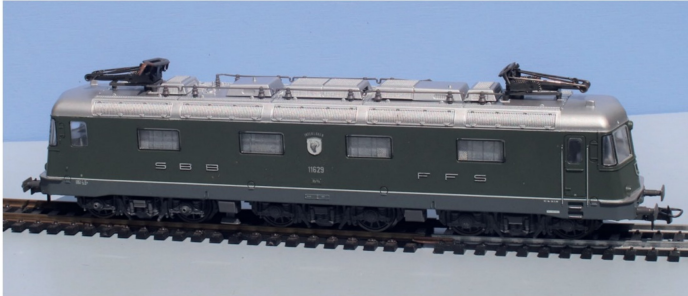
1989 kündigte sich die komplette Überarbeitung der Re 6/6 an. Schliesslich wurden von den Serienloks zehn Varianten gefertigt, hier die Re 6/6 11629 «Interlaken» (Art.-Nr. 208184 S01).
