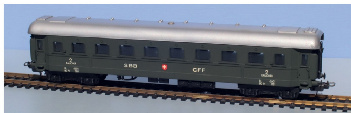
Das hier abgebildete Modell war 1963 das erste Fahrzeug von Lima in der Schweiz (Art.-Nr. 9106). Es handelt sich um eine Farbanpassung eines FS-Wagens vom Typ Bz 1959 mit SBB-Beschriftung.
