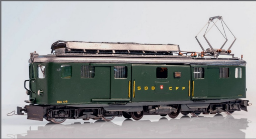
Der SBB-Zahnradtriebwagen als Deh 4/6 mit Zahnradrehgestell...
