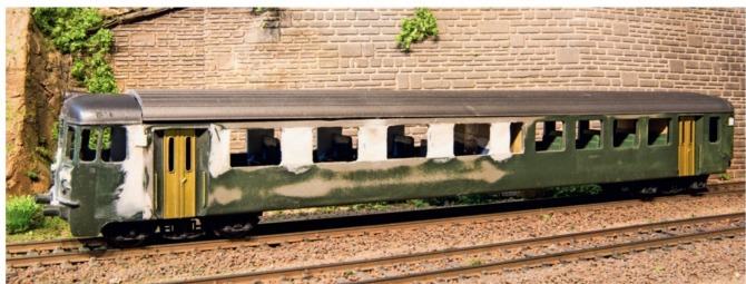
Hier sieht man deutlich, wie der Wagen aus einem herkömmlichen EW I entstanden ist.
