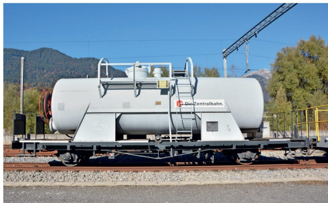
Der X 761 der ZB besteht aus einem Originalkessel und dem Untergestell vom SBB Gb 2214.
