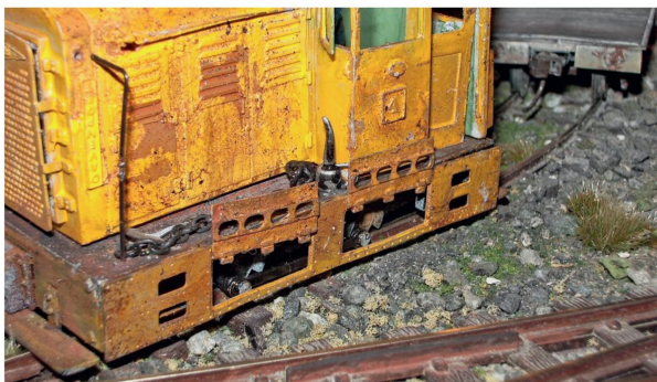
Die Klappen sind aufgeklappt, die Stangen können geschmiert werden.
