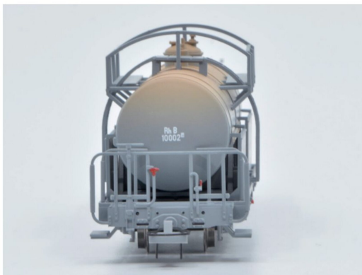
Die Bremsplattform mit der dominanten Bremsspindel am RhB-Wagen.
