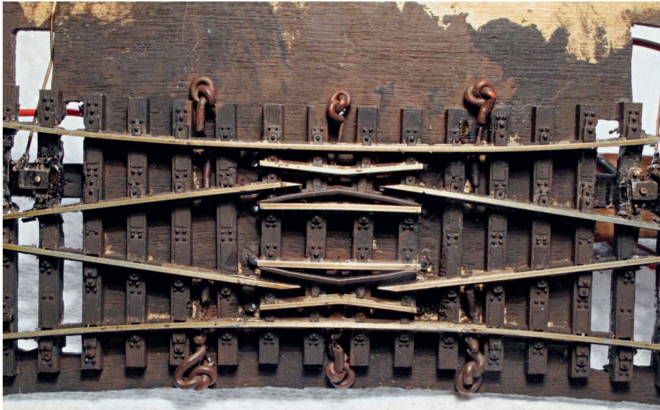
Die beiden Verschlüsse sind nun mit korrekter Länge der Verschlussstücke montiert.
