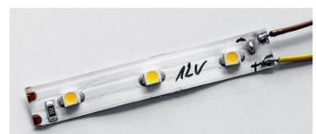
Die Kontaktpunkte und die Enden der Kabel werden vorverzint und miteinander verlötet. Dazu wird zwingend ein Lötkolben mittlerer Leistungsklasse mit feiner Spitze benötigt.
