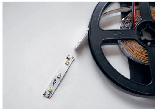
Ein Schnipp mit der Schere an den kupfern glänzenden Kontaktpunkten, und schon hat man ein erstes Lichtelement. Die Polarität und die Spannung werden mit einem feinen schwarzen Filzstift notiert, damit später bei der Verdrahtung nichts schiefgeht.
