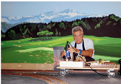
Gleiskürzung mit einer auf einem Rollbrett fixierten Trennscheibe.
