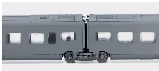
Kurzkupplung auch im Modell, dies dank den Jakobs-Drehgestellen.
