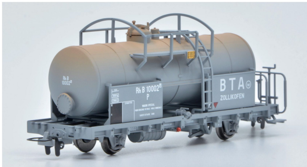
Eine Typenaufnahme vom RhB P 10002 mit dem gealterten Kessel. Am Pufferbalken sind die Löcher für die Zurüstteile zu erkennen.
