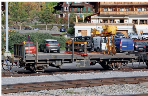
Die MOB baute 2000 den P 891 zum Schienentransportwagen X 53 um.
