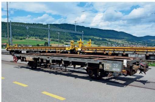
Der SBB P 8911 wurde bei der CJ zum Container-Flachwagen umgebaut.
