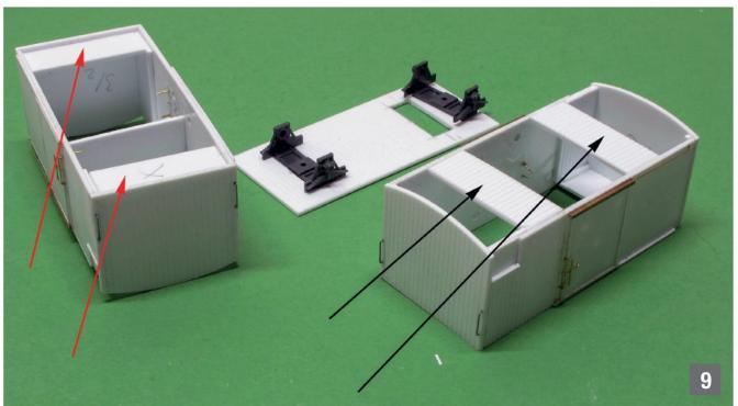
an den Leimstellen reissen. Am Boden müssen nun die Ausschnitte für die Achslager ausgeschnitten werden. Da gehe ich gleich vor wie bei den Fenstern. Am Wagenkasten werden unten mit 1 mm Abstand (damit der Boden plan liegt) je zwei Verstrebungen eingeleimt (rote Pfeile). An diesen wird später der Boden festgeschraubt. Oben werden noch zwei Verstrebungen für die Dachbefestigung eingeleimt (schwarze Pfeile).
