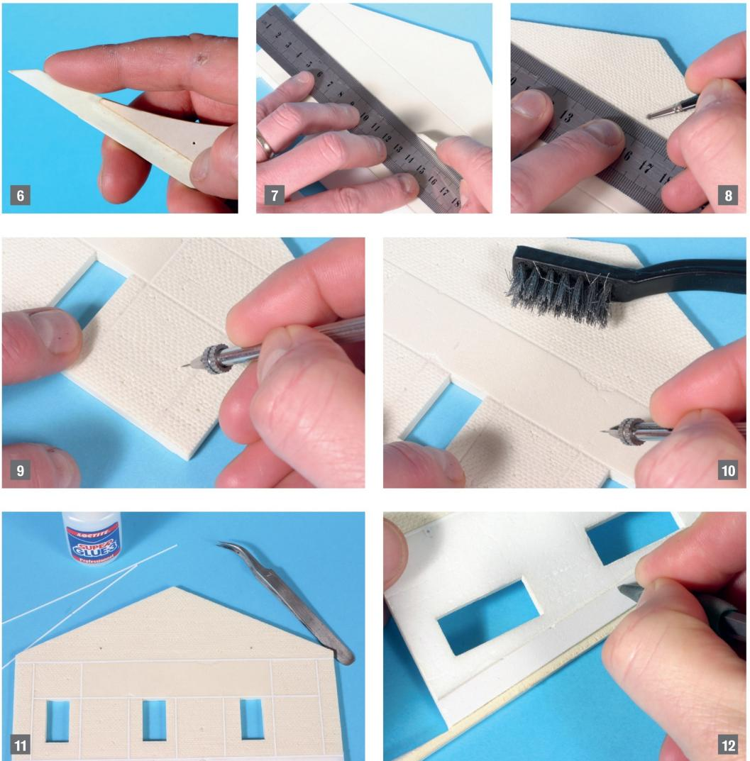
Klinge zu verwenden, um zu vermeiden, dass der zwischen den beiden Kartonschichten liegende Schaumstoff reisst. Wenn die Öffnungen fertig ausgeschnitten sind, wird die Oberfläche vom Schaumstoff abgezogen.
