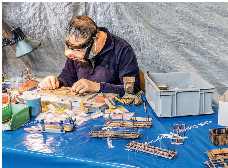
Wie aus Messingplatten und -profilen Modellbahnfahrzeuge zusammengelötet werden, konnte live miterlebt werden.
