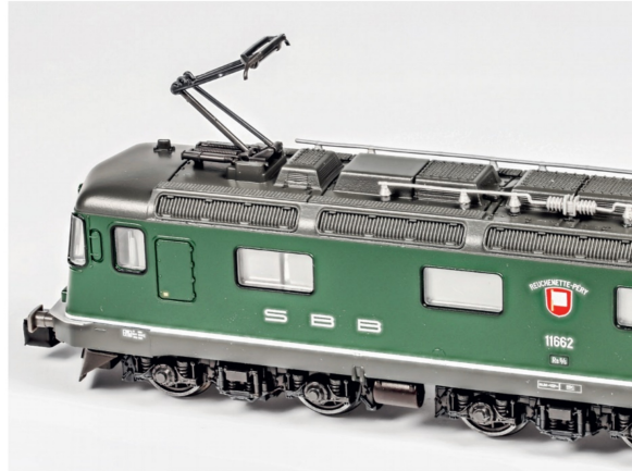
Der schmale Pantograf aus Kunststoff: ein echter optischer Gewinn.
