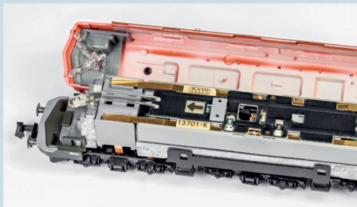
Das Lokgehäuse ist abgenommen, die KATO-Platine noch am Platz.
