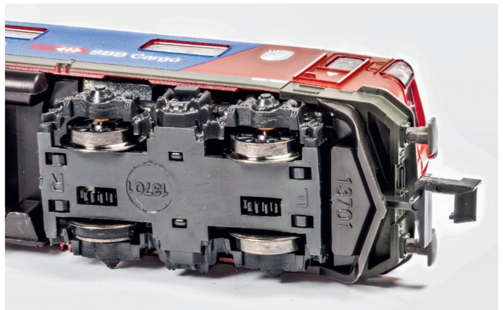
Drehgestell von unten: nach unten offene Getriebe sowie die Anordnung der Räder mit Haftreifen.
