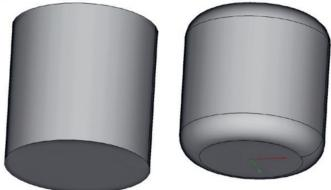
Zweites Beispiel: Ersatzpuffer für den Hochbordwagen von Lima (Eaos). Sie kennen das Problem bei den Hochbordwagen Eaos von Lima mit den abgebrochenen Puffern auch? Also, sorgen wir für Ersatz! Die Masse nehmen wir vom Originalpuffer des Modells ab. Diese ergeben:
