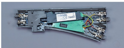
Für Bettungsgleise gibt es Decoder, die direkt in der Bettung sitzen. In dieser Märklin-Weiche finden ein Antrieb und der Decoder problemlos Platz. Der Stromabgriff für den Decoder erfolgt direkt in der Weiche.
