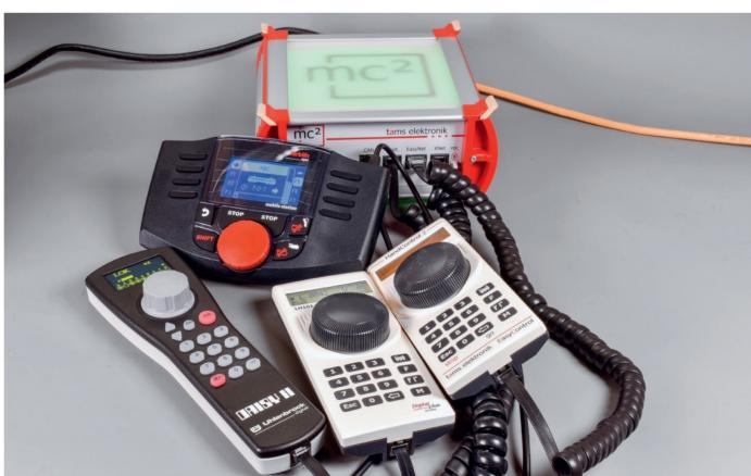
Beim Digitalausbau kann der Handregler aus der Startpackung weiter verwendet werden. Zentralen wie die mc² von Tams ermöglichen den Anschluss nahezu aller gängigen Handregler.
